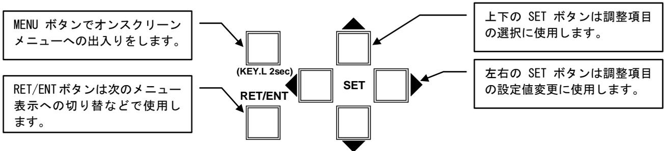
MENU 押しボタンの長押しでキーロック状態への設定・解除ができます。
