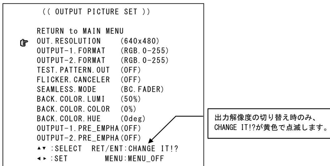
出力解像度は、OUTPUT-1 と OUTPUT-2 にて同じ解像度となります。カラー形式は個別に設定可能です。OUT. RESOLUTION にカーソルを合せ、SET 左右で目的の解像度を表示し、RET/ENT 押しボタンを押します。RET/ENT 押しボタンを押すまでは設定が適用されません。
