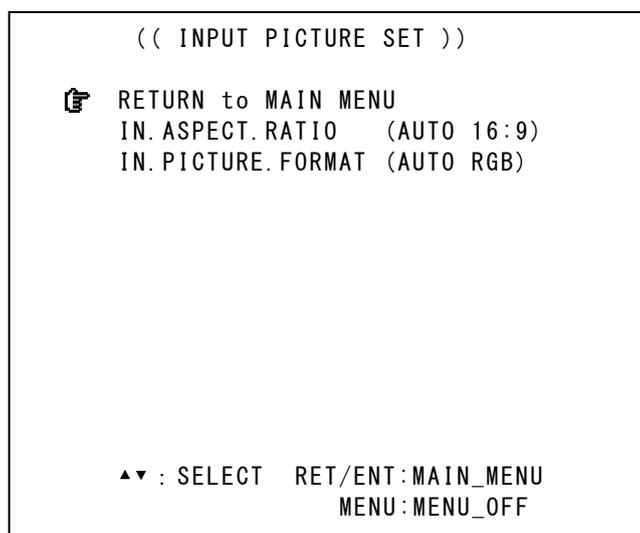
カーソルを調整したい項目に SET 上下押しボタンで合せ、SET 左右押しボタンで設定値を変更します。設定変更はすぐに映像へ適用され、後にバックアップメモリーにも保存されます。
