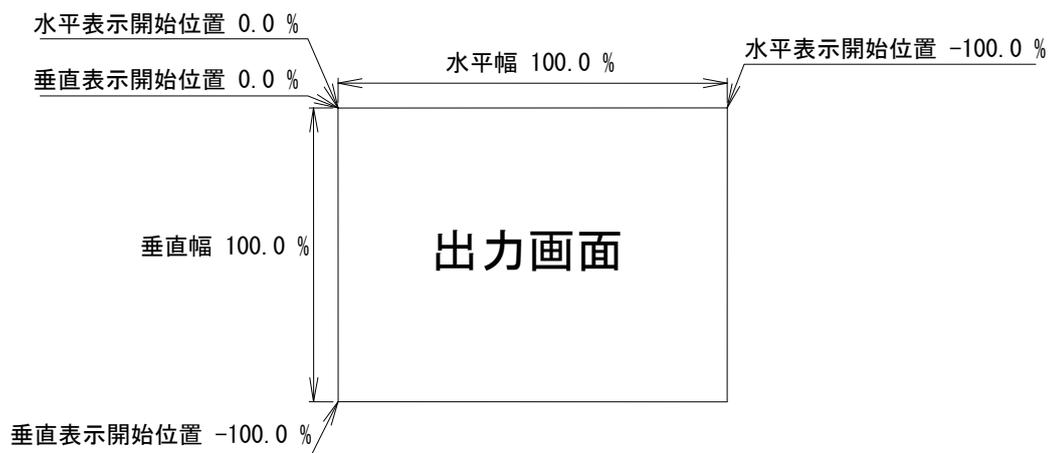
上図は、1つの出力画面（表示機器の画面）を表しています。マルチ画面動作設定が OFF の時の、出力画面イメージです。このとき、レターボックス・サイドブランク表示時のバックカラー表示部分も含まれます。出力画面が 4:3 でも 16:9 でも、各%数値は同じです。
