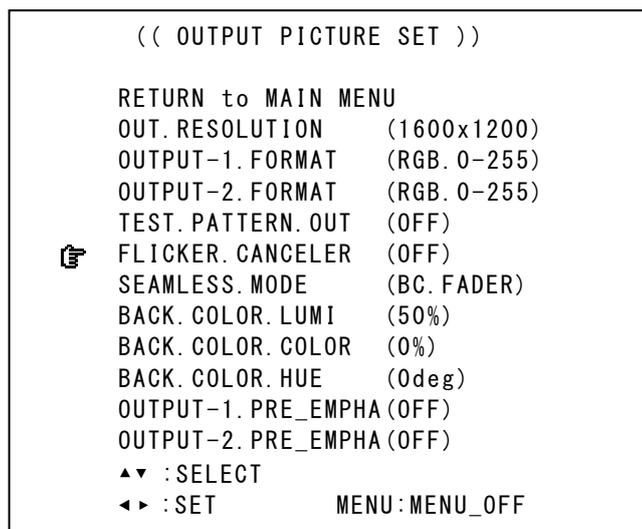
工場出荷設定は OFF です。システムでの必要に応じて、WEAK, MIDDLE, STRONG から選択できます。フリッカー抑圧能力を高くするに従って、垂直解像度も多少劣化します。
