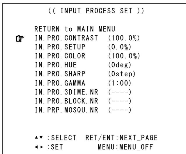
この INPUT. PROCESS. SET メニュー表示時のみ、RET/ENT 押しボタンを押すことによりオンスクリーン表示を映像画面下部へ小さく表示し、調整中の映像画面の確認を容易にすることができます。
