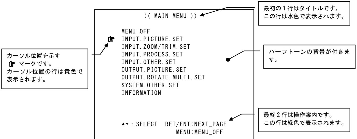
メインメニュー表示で調整したい項目にカーソル
