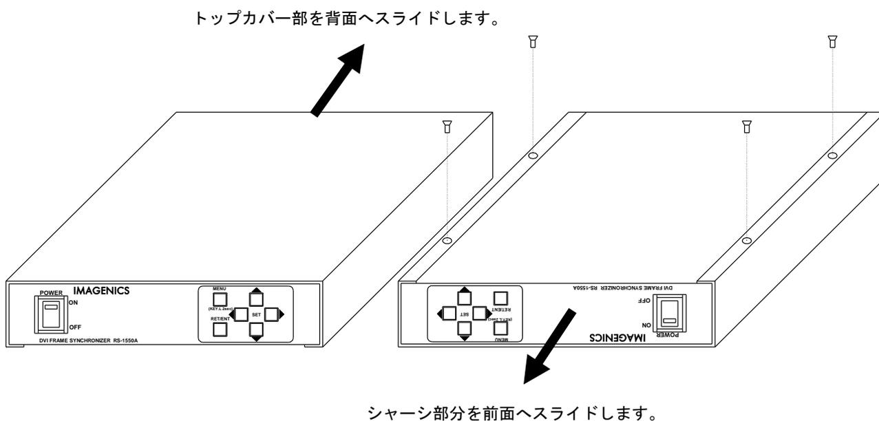
トップカバーとシャーシを分離するには、まず、トップカバーの下部合計 4 本の M3-サラネジを取り外し、左図の様にシャーシ部を手前へ、トップカバーを背面側にスライドさせて分離します。
